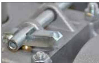
Desbloqueo externo a través de cable metálico
