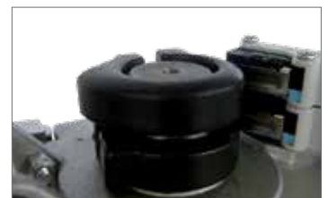
Fin de carrera con regulación de alta precisión
